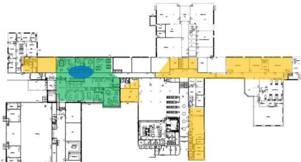
Kuva 4. 1. kerroksen betonialapohja-alueen mikrobivaurioituneet alueet (keltaisella). Vihreällä on merkitty vuonna 2017 korjattu alue ja sinisellä kosteuspoikkeama-alue.
